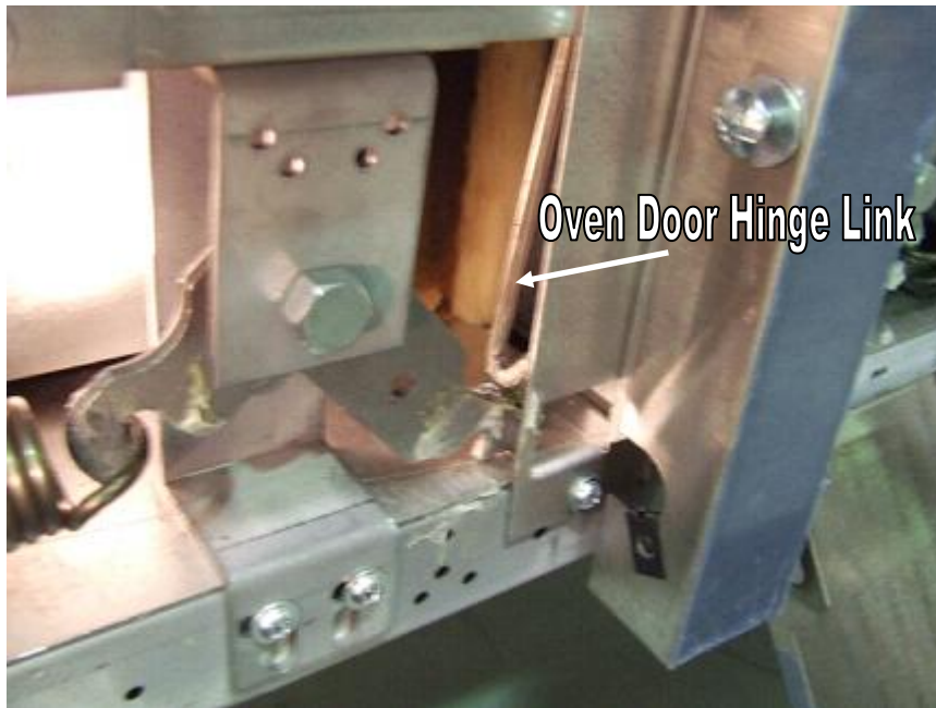
Unhooked oven door hinge link
