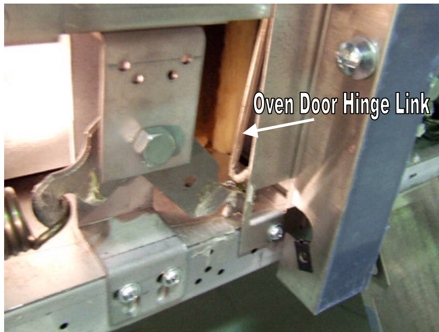
Unhooked oven door hinge link
