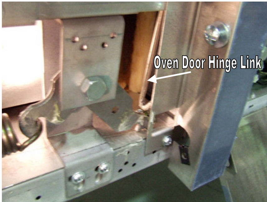
Unhooked oven door hinge link
